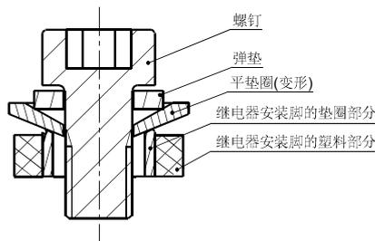
使用M5螺钉时，需确保垫圈厚度和强度足够，否则会变形，撑破外壳。
